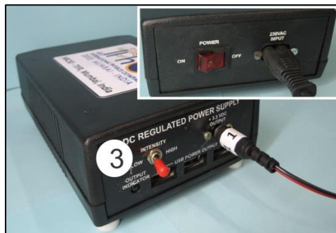
Рис. 4: Регулируемый источник постоянного тока
