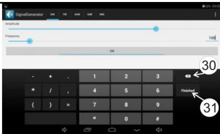
Рис. 6: Экран с цифровой клавиатурой для ввода частоты
