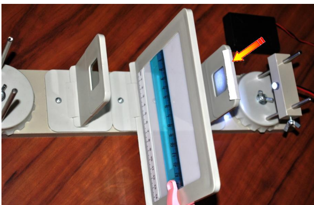
Рис. 1В Установка для наблюдения двойного лучепреломления в линейке
