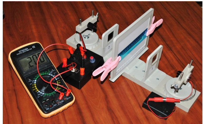
Рис. 4В Установка для измерения пропускания света через пластиковые линейки
