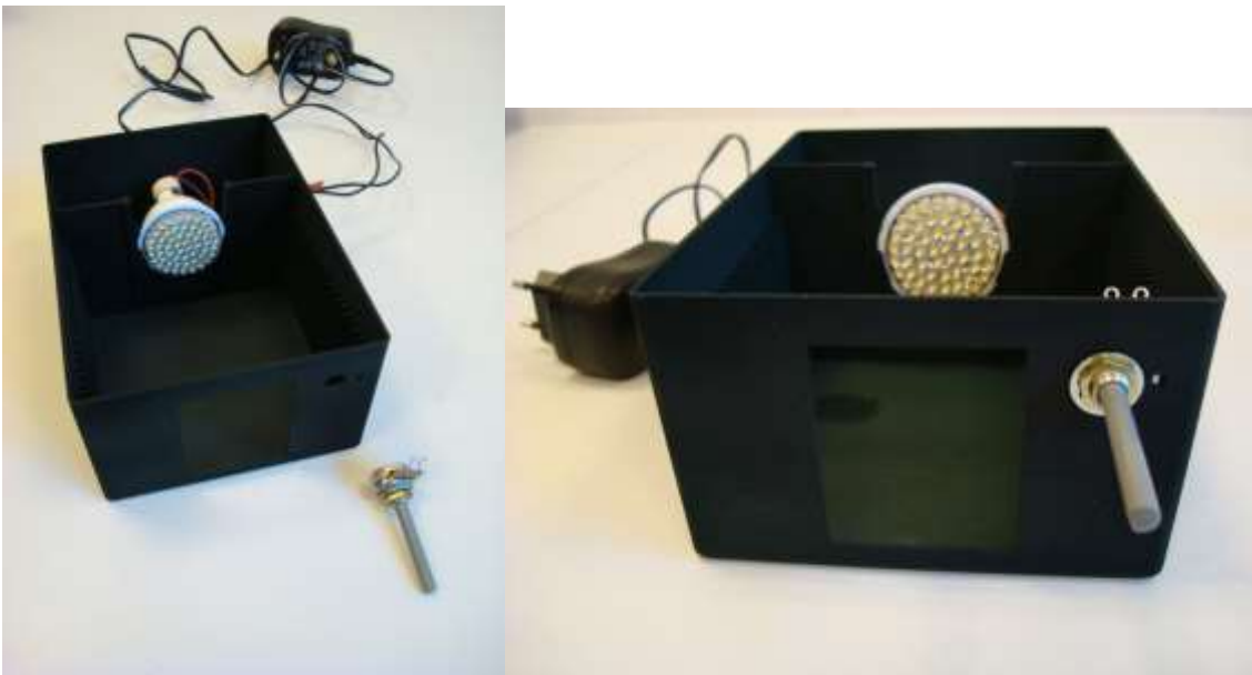
Рис. 2.2 (а) Коробка с источником света и резистором для крепежа. (б) Переменный резистор, закрепленный в коробке. Заметьте, что небольшой штифт на резисторе подходит под отверстие справа от рукоятки.
