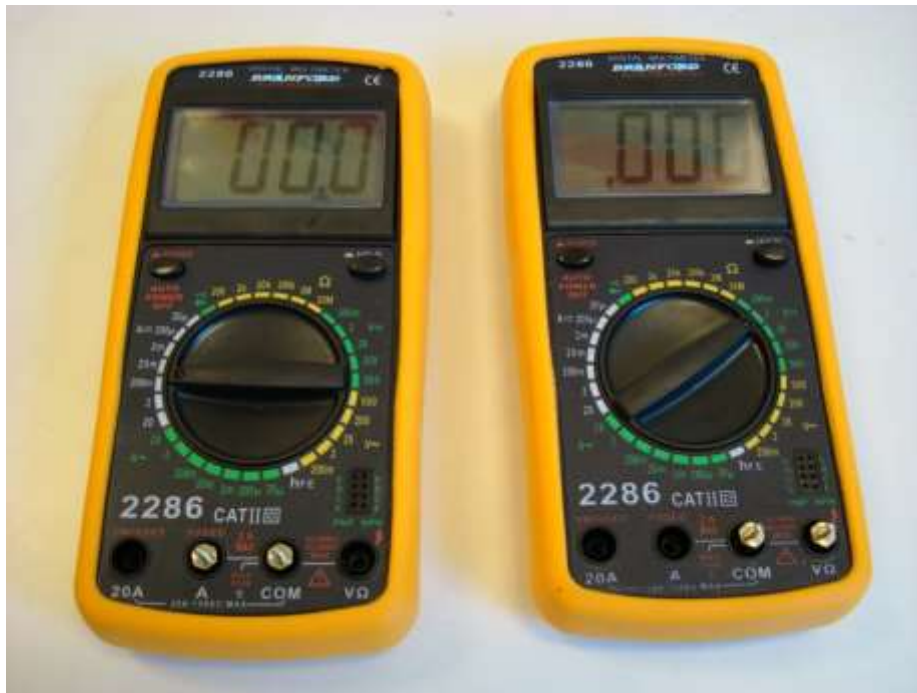
Рис. 2.3 Мультиметры с указанием выводов, которые разрешено использовать. Левый мультиметр используется как амперметр, правый – как вольтметр. Прибор включается нажатием кнопки “POWER” в левом верхнем углу. Прибор выключается автоматически после некоторого времени простоя. Он может измерять как постоянный ток и напряжение (=), так и переменный ток и напряжение (~). Внутреннее сопротивление вольтметра – 10 МОм вне зависимости от диапазона, в котором вы работаете. Разность потенциалов на амперметре – 200 мВ при максимальном значении тока в диапазоне вне зависимости от диапазона, в котором вы работаете. В случае «зашкаливания» дисплей покажет “1”, и тогда нужно выбрать диапазон измерения бóльших значений. Кнопка “HOLD” (в правом верхнем углу) позволяет зафиксировать показание, если вам это потребуется.
