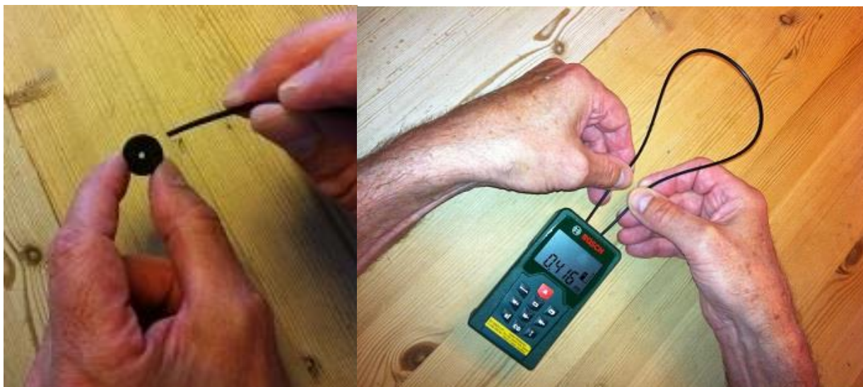
Рис. 1.5 (а) Войлочная прокладка и оптоволокно. (б) Присоединение оптического волокна.
