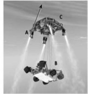
Рис. 7. Посадочная система А – один из двигателей В – марсоход «Curiosity» С – космический кран
