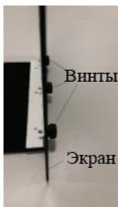
Рис. 10. Экран крепится к платформе с помощью трех винтов.
