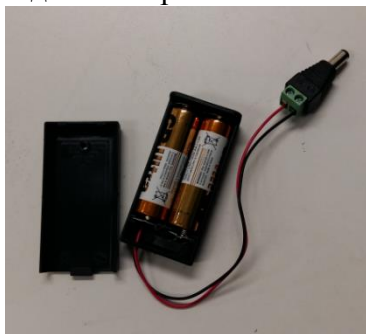
Рис. 3. Блок питания, состоящий из двух батареек по 1,5 В с разъемом для подключения к полупроводниковому лазеру
