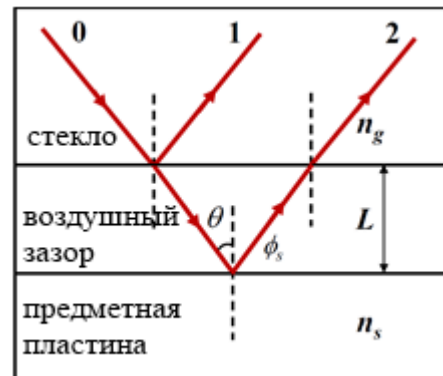
Рис. 10. Отражения света от идеального эталона Фабри-Перо с воздушным зазором, состоящего из верхней стеклянной пластины и нижней предметной пластины.
