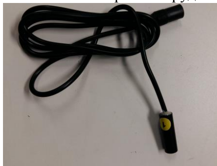
Рис. 2. Полупроводниковый лазер с выходной мощностью 0,5 мВт на длине волны 650 нм
