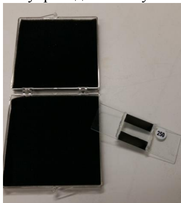
Рис. 6. Коробочка для образцов и один эталон Фабри-Перо с титановым покрытием (для примера, номер эталона на этой фотографии — 250)
