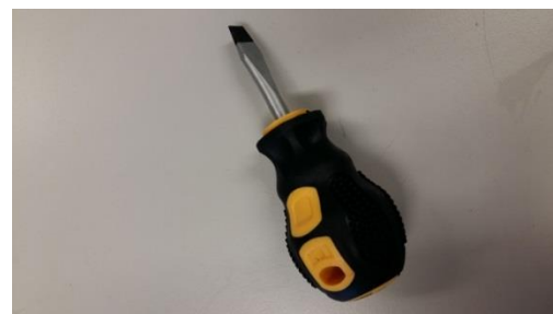
Рис. 7. Отвертка с плоским наконечником для настройки диаметра лазерного луча
