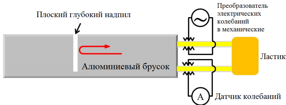
Рис 14. Схема эксперимента для определения дефекта в бруске
